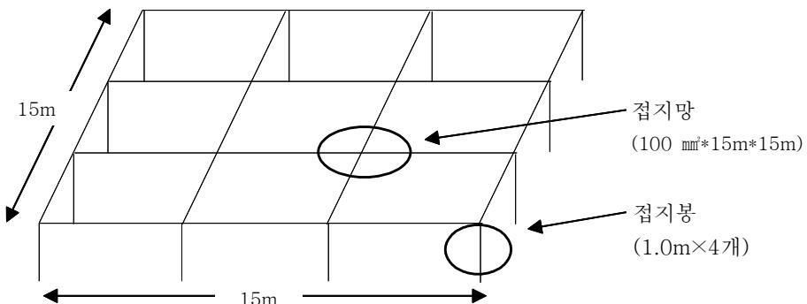
그림 A-9. 22.9kV 1,500kVA급 옥외 수전설비 변전소 접지망 구성도
